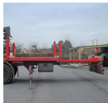
*Porte à faux maxi des poteaux 3 m au-delà du dernier appui et 5 m par rapport au milieu de l'essieu arrière. Lanterne signalétique rétro-réfléchissante.*
