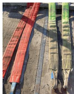
Si vous utilisez des câbles en acier ou des chaînes, vous devez **impérativement protéger** le contact acier contre béton pour éviter les épaufures et le glissement du poteau.
